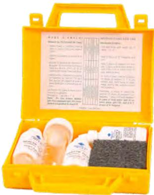
Mesure de TH par kit test colorimétrique.
